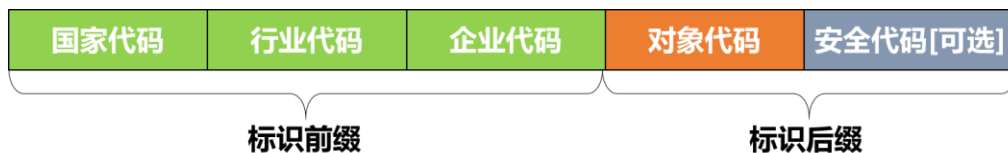
图2 工业互联网标识编码结构
