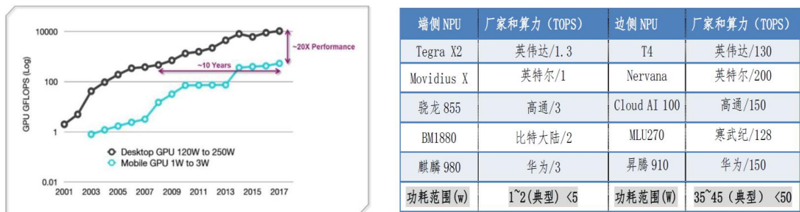
图 3. 桌面（版级）GPU 与移动 GPU 渲染能力对比
